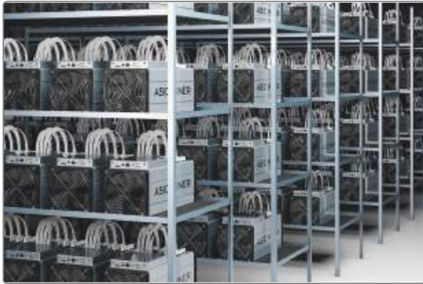
Görsel 1.9: ASIC sistemi ile madencilik ekipmanı
