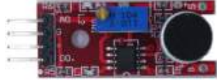
Görsel 2.40: Ses sensörü ve pin yapısı
