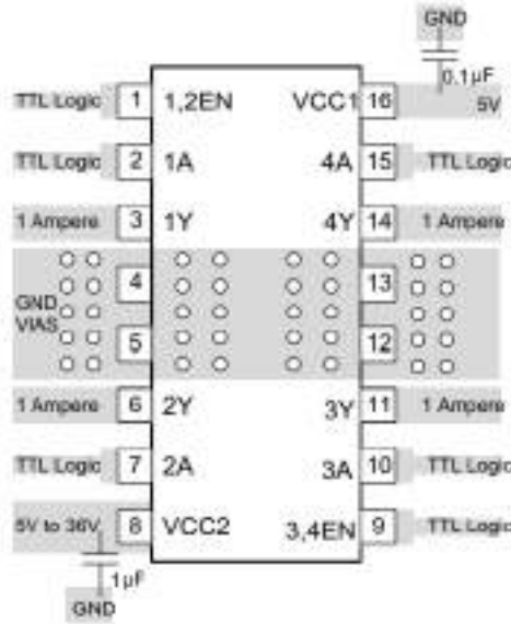
Görsel 2.14: L293(D-B) motor sürücü entegresinin pin yapısı
