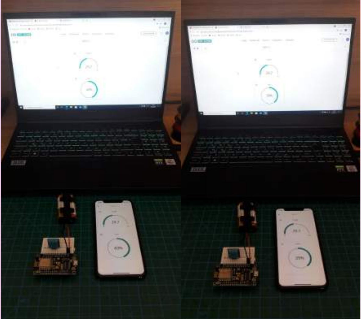
Görsel 7.57: DHT-11 ile ortamın sıcaklığını ve nemini aktaran IoT nesne tasarımı
