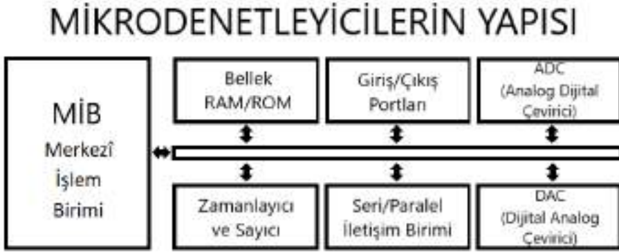
Görsel 2.24: Mikrodenetleyici iç yapısı
