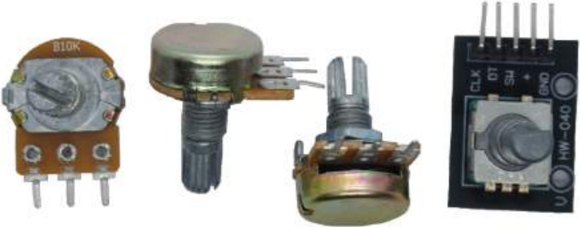
Görsel 2.3: Potansiyometre (Ayarlanabilir direnç)
