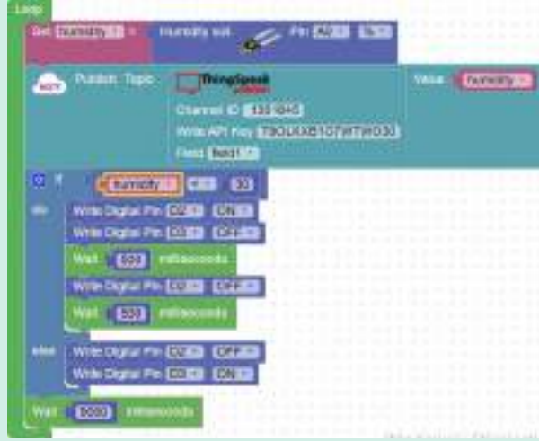
Görsel 6.32: Dijital pinlerin ON-OFF pozisyonuna geçmesi
