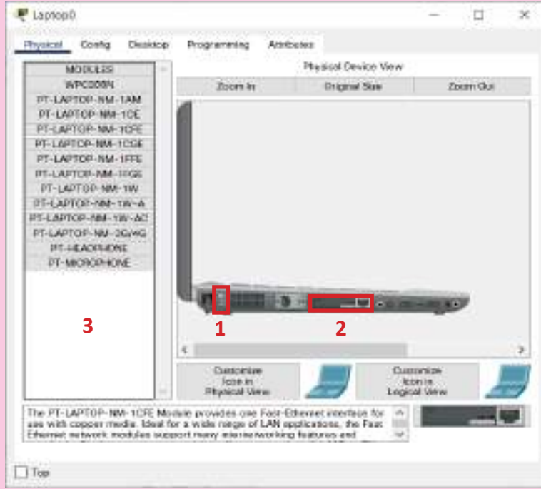
Görsel 1.10: Dizüstü (Laptop) uç nokta cihazının Ethernet modülünü çıkarma
